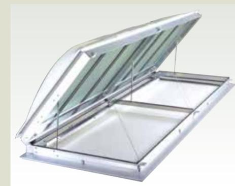
50°のワイドな大開口と、外付トーションバー方式により有効開口面積を向上させた「ESHL」。アルミとステンレスの複合一体枠により、耐火補強を実現。大量採光・大量換気が必要な大型の建築物に適します。
