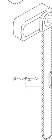
1. 表示ホルダー側のボールチェーンを下(開表示方向)に引くと窓が一斉に開放します。
