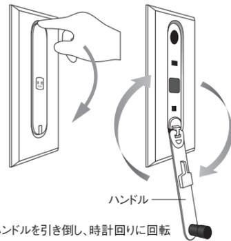
2. ハンドルを引き倒し、時計回りに回転させ続けると窓が閉鎖します。
